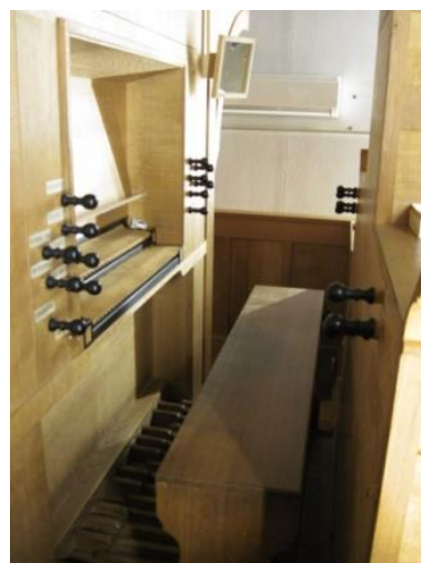
バッハの森のパイプオルガン 独ユルゲン・アーレント工房製作(1989年) 2段鍵盤 + ペダル メカニカルアクション・19ストップ
