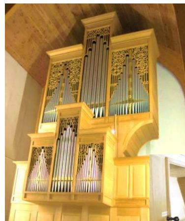
バッハの森のパイプオルガン 独ユルゲン・アーレント工房製作 (1989年) 2段鍵盤 + ペダル メカニカルアクション 19ストップ
